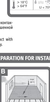
Перед укладкой обеспечить хранение ламинированных полов в горизонтальном положении, в упаковке, в течение 48 часов при комнатной температуре (не менее +18°C) и влажности воздуха не более 70%. Упаковку (пленку) вскрывать непосредственно перед укладкой. После укладки необходимо проверять помещение.
